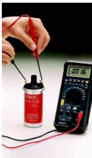
▶ Medición del enrollamiento secundario
