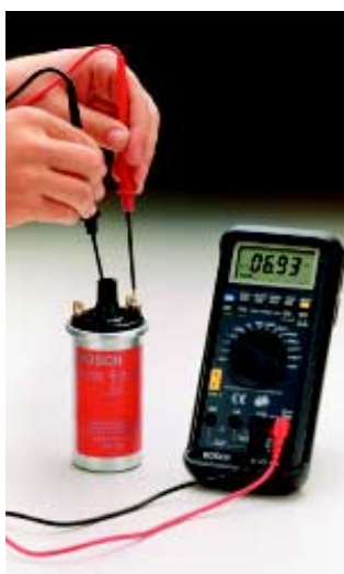
▶ Medición del enrollamiento secundario
